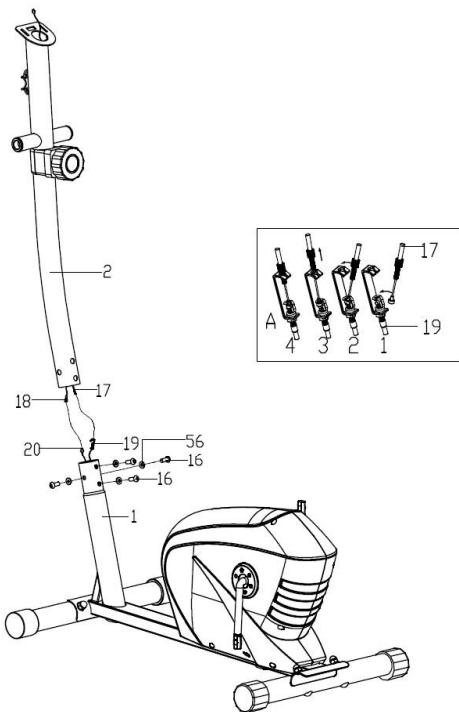
Σύρετε το παξιμάδι του άνω καλωδίου ρύθμισης αντίστασης (17) στην υποδοχή των βραχίονα του καλωδίου ρύθμισης αντίστασης (19), τραβήξτε και σφίξτε το άνω καλώδιο (17) και μετακινήστε το κάτω βραχίονα καλωδίου (19) κάθετα. Το παξιμάδι καλωδίου πρέπει να βρίσκεται στο βραχίονα όπως φαίνεται στην εικόνα.
